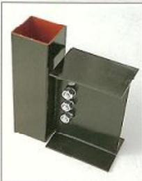
超高層ビルにも使用される3.2mm厚・100mm角の「角パイプ柱」。約20tの家なら一本で約半分の重量を支えられます。また工場生産時の塗装により、外部の腐食環境から完全に遮断。塗りムラのない美しい仕上がりで、現場塗装の必要がないためシンナー悪臭も発生しません。
